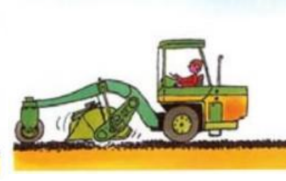
Mezclado suelo /agua/ emulsión y compactación de la mezcla
