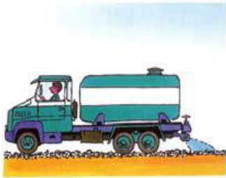
Humectación, perfilado y mezclado
