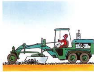
Humectación, perfilado y mezclado
