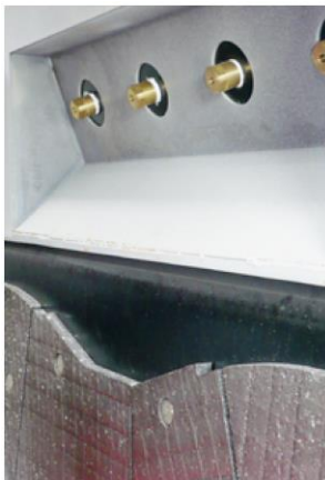
Par le biais de buses de projection, le bitume de mousse est acheminé jusqu'au mélangeur.
