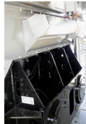
Vue extérieure : Mélangeur doté d'un générateur de mousse.
